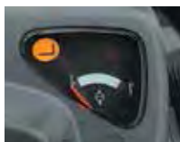
Контрольная лампа блокировки подъема на панели приборов
